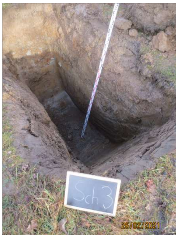
Bild-Nr. 13: Bodenprofil von Baggerschurf Sch 3 bis 2,8 m u. GOK.
