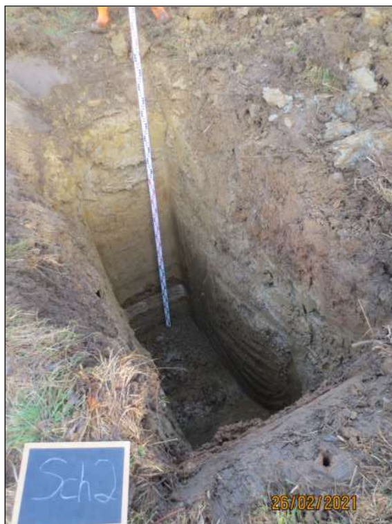
Bild-Nr. 11: Bodenprofil von Baggerschurf Sch 2 bis 3,2 m u. GOK.
