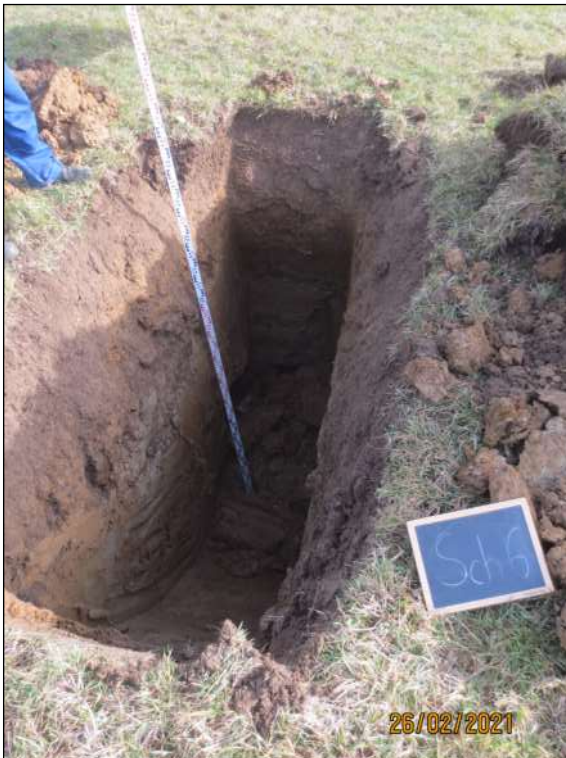
Bild-Nr. 21: Bodenprofil von Baggerschurf Sch 6 bis 2,9 m u. GOK.
