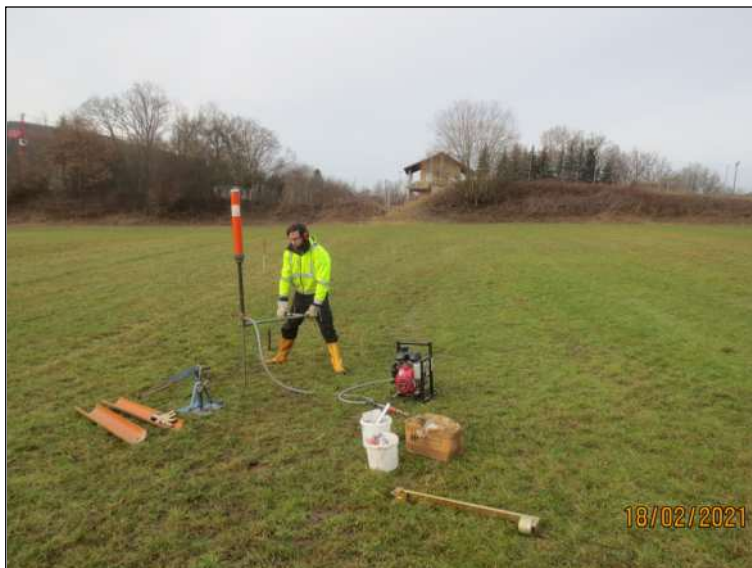
Bild-Nr. 7: Laufende Rammsondierung. Blickrichtung Nordosten.
