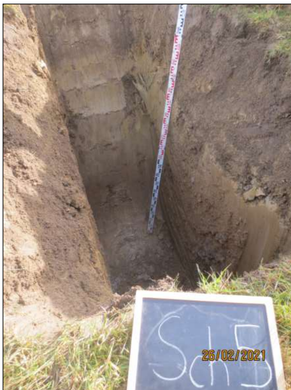
Bild-Nr. 19: Bodenprofil von Sch 5 bis 2,3 m u. GOK.
