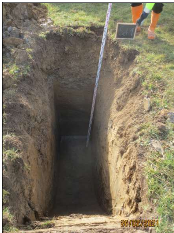
Bild-Nr. 9: Bodenprofil von Sch 1 bis 3,0 m u. GOK.
