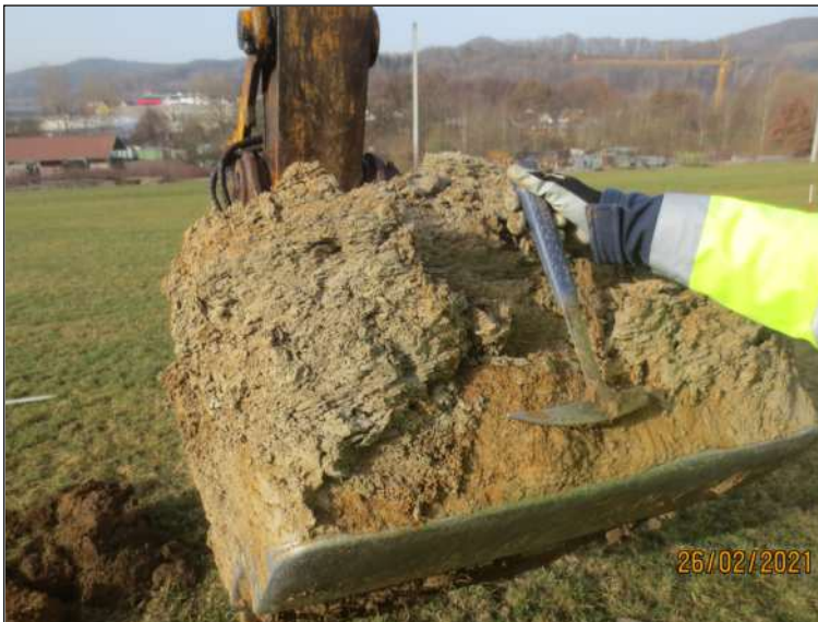
Bild-Nr. 17: Detail von Sch 4 mit Aushubmaterial der Schicht 2b.
