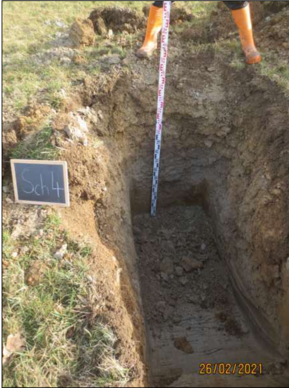
Bild-Nr. 16: Bodenprofil von Sch 4 bis 1,7 m u. GOK.
