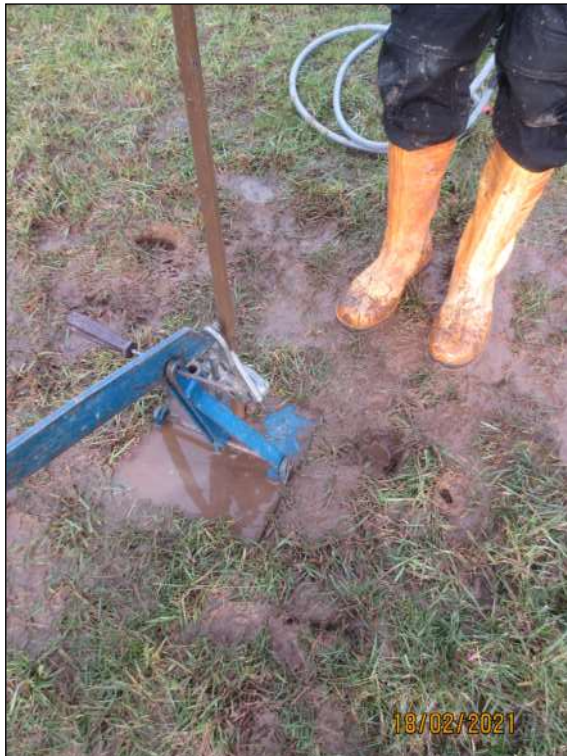
Bild-Nr. 6: Vernässung des Oberbodens (Stauwasserverhältnisse).
